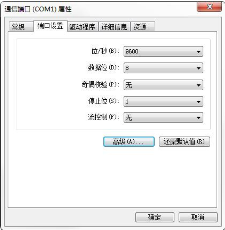
图 1-2 “超级终端”中的通信参数配置示意图
