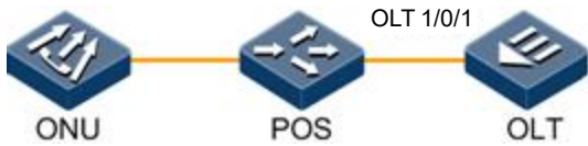
图 2-2 ONU 自动注册组网示意图
